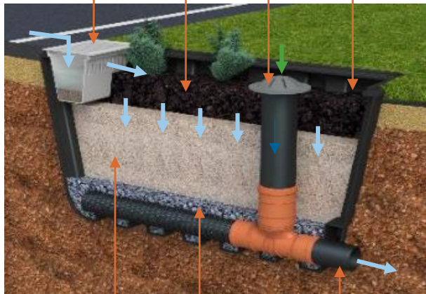
Warstwa filtrująca Warstwa retencyjna Wylot
