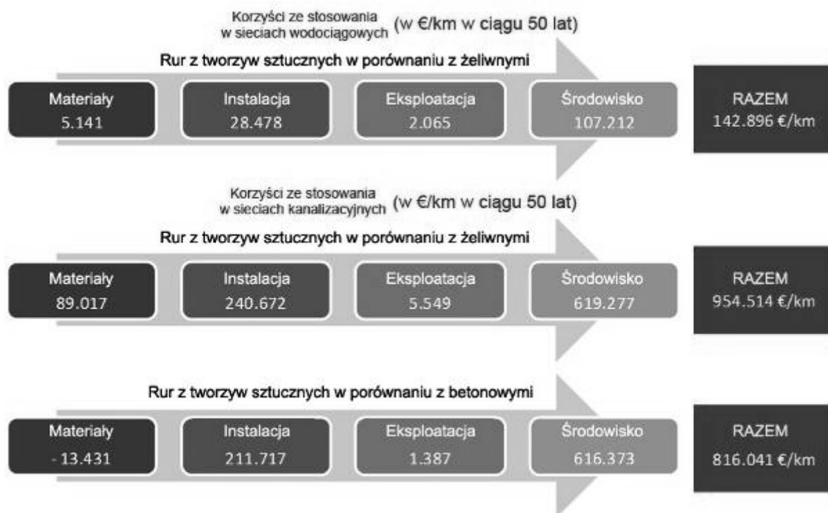
Rys. 10: Korzyści wynikające z unowocześniania rurociągów
